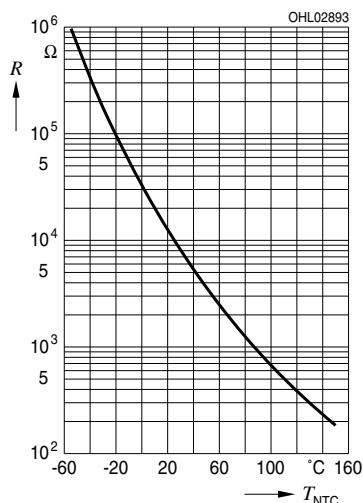
**SMD NTC Thermistor with Nickel Barrier Termination, Type 0603****SMD NTC Thermistor mit Nickel Barrier Termination, Typ 0603**
